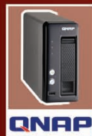
Сетевой накопитель QNAP TS-119P+ TurboNAS с центральным процессором Marvell 1,6 ГГц
